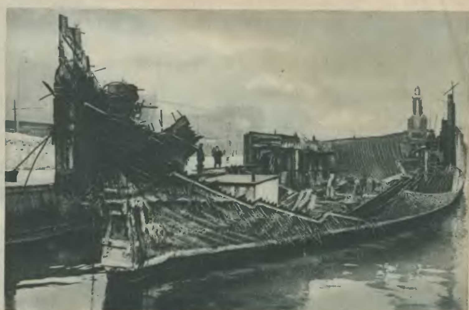
Ein Holzdampfschiff, das in Amerika während des Weltkrieges zur Truppenbeförderung gebaut wurde, wird im Kieler Hafen abgebracht. Schirmer
